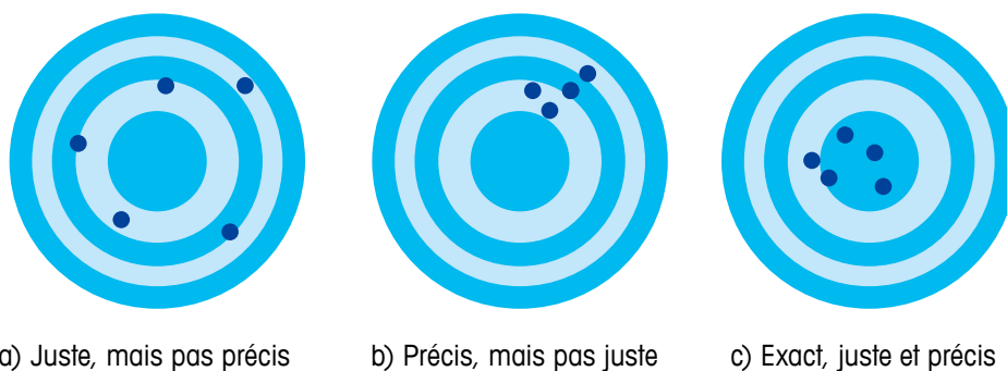
Figure 4 : l'exactitude est une combinaison de justesse et de précision
